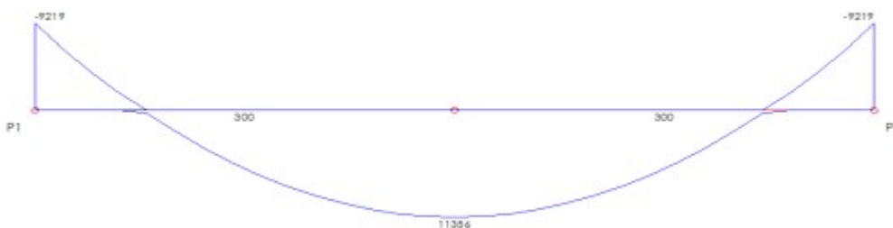
MOMENTOS FLETORES DE CÁLCULO ( M_{dx} ) [kgf.m;cm] VIGA: V1
